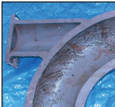
一般的な腐食（流れの影響） （写真提供：Energy Institute, London）
